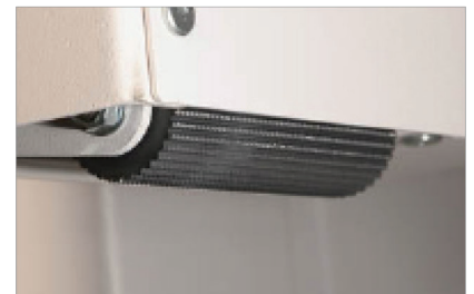
Verbeterd PGO-opruwstelsysteem voor rug-preparatie, speciaal voor moeilijk, dik en gecoat papiersoorten
