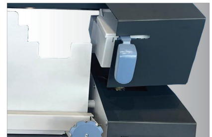
Veilige constructie, geen risico op vingers tussen de rollen.
