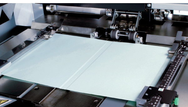
Omslagen worden automatisch gerild en op de kneptafel gelegd
